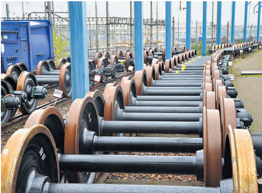
Ersatzteillager. Hinter der Muttenzer Werkhalle lagern neue Radsätze. Auf der Spezialfarbe lassen sich Verschleisserscheinungen besser erkennen.
