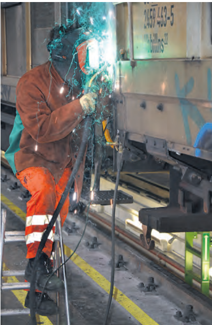
Schweisstreibend. Ein Arbeiter besetzt eine Delle am Güterwagen aus.
